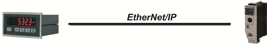
Şekil 5.15 - BX11 EI bağlantısı
